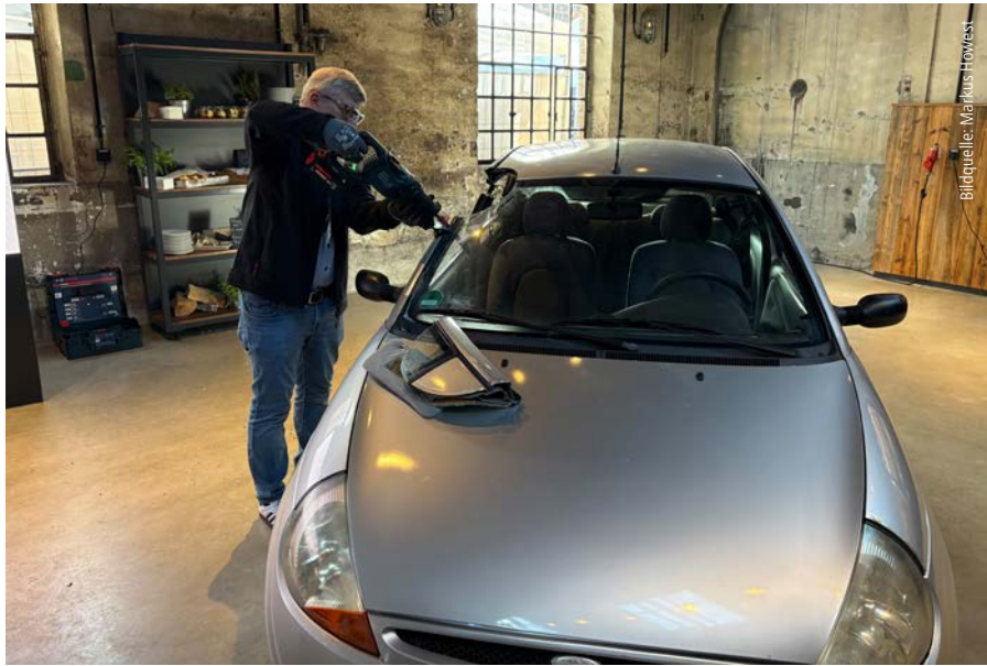
Eines der Highlights am Bosch Pro Experience Day: die Säbelsäge EXPERT EXSA18V-32, die nicht nur leistungsstark ist, sondern als erste Säbelsäge über eine KickBack Control verfügt, die das Gerät beim Verkanten des Sägeblatts augenblicklich stoppt, hier bei der Probe-Anwendung an einem PKW.
